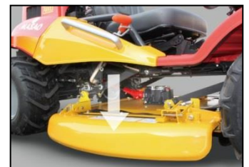
Ajuste de la altura de corte deseada
