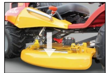
Ajuste de la altura de corte deseada
