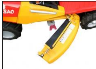
Corte rotativo mediante transmisión por correa
