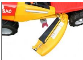
Corte rotativo mediante transmisión por correa
