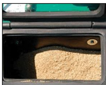
Tolva sembradora integrada de 11'3 kg. de capacidad
